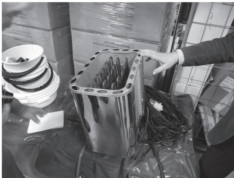
写真4 サウナユニットに使用する電熱ヒーター (7kW)
